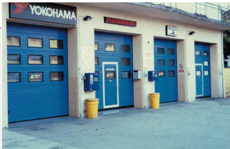
Portoni sezionali con inserimento multiplo su più pannelli di oblo' rettangolari, e porta pedonale inserita.
