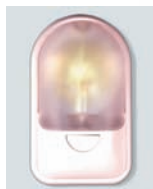
4 Lampada di cortesia interna con autospegnimento dopo 60''
